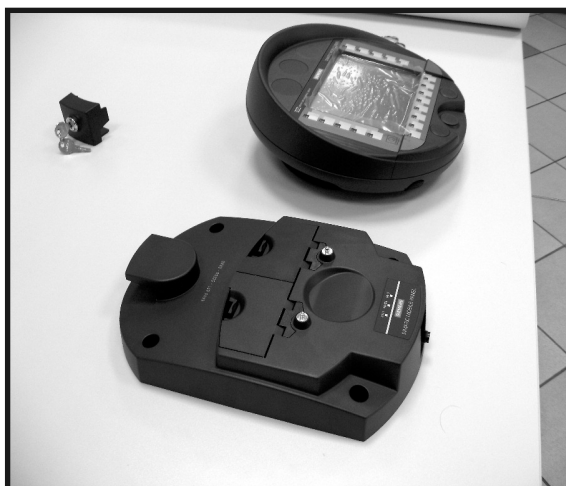
Nabíjecí stanice ovládacího panelu
