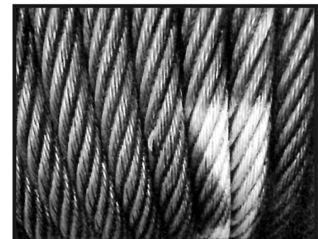
Lano na bubnu věžového jeřábu poškozené důsledkem nedostatečného napětí při první instalaci.
