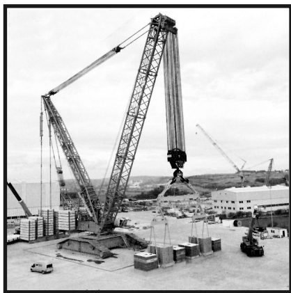
Liebherrský pásový jeřáb s 3000t kapacitou LR 130000 na testování v Liebherr-Werk Ehingen v Německu
