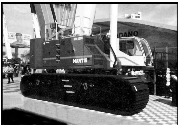
Jim Lamb z Tedano Mantis představil nový 12 tunový GTC-1200 pásový jeřáb s teleskopickým výložníkem.
