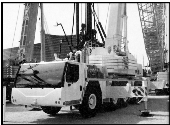
Překvapení připravil Liebherr se svým LTM 1160-5.2. Jde o mobilní jeřáb s teleskopickým výložníkem o délce 62metrů. Pohon podvozku i jeřábu zajišťuje jediný 400kW dieselový agregát.
