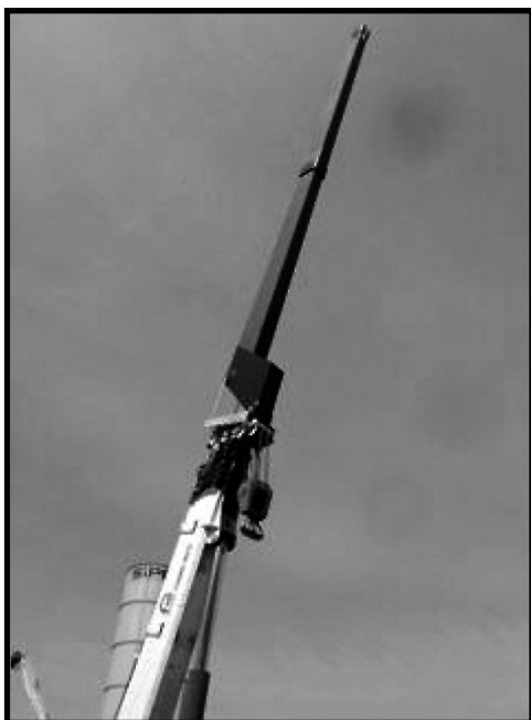
Výložník je zkonstruován pro mobilní jeřáby, měří 14 metrů a skládá se ze dvou částí.
