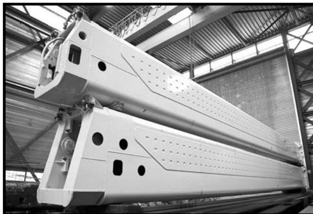
Avezaat provedl opravu dvou částí výložníku mobilního jeřábu Terex-Demag AC 100
