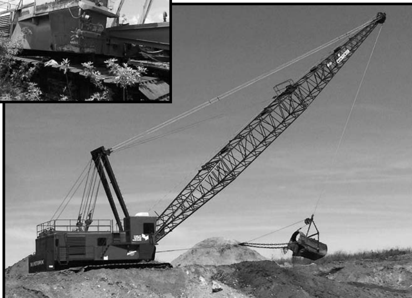
H&E Equipment Services zrekonstruovali pásový jeřáb Manitowoc 4600 pro firmu United States Gypsum ze Chicaga.
