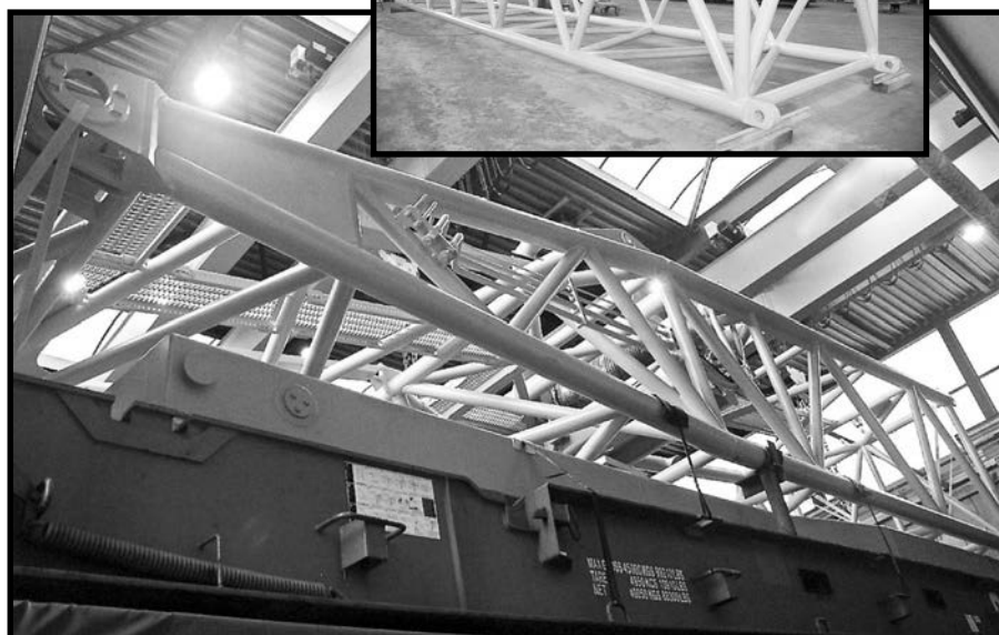
Nová sekce výložníku jeřábu Hitachi Sumitomo SCX 2500 provedená fitmou Avezaat
