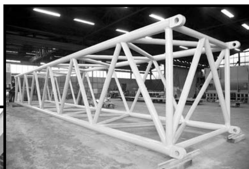
Částečně rekonstruovaný výložník jeřábu Terex CC 2500
