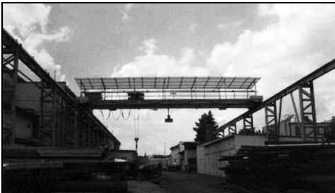
Obr. č. 3 Elektrický mostový jeřáb řízený rádiovým ovládačem ze země.
