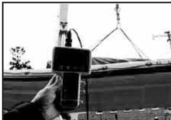
Bezdrátový snímač Radiolink Plus schopný statického i dynamického vážení.
