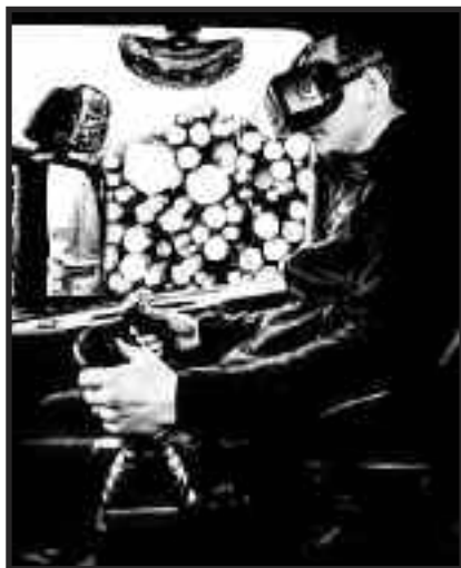
Hiab's HiVision pro dálkové ovládání jeřábu pomocí brýlí zobrazujících obrazy z kamer.
