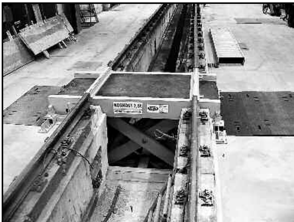
Hříž v základní poloze umožňuje přejezd vozidel s hmotností 22,5t/nápravu
