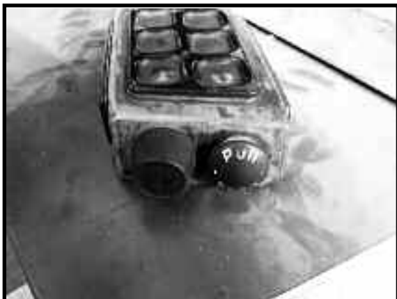
kontrované pracoviště – rádiové dálkové ovládací zařízení HEATRONIC typ: ERGO V4 k obsluze mostového jeřábu Vihorlat Snina VÚDÚT VT-1 (rok výr.: 1991; nosnost: 5000 kg) – ovládací prvky rádiového dálkového ovládacího zařízení byly zaneseny nečistotami
