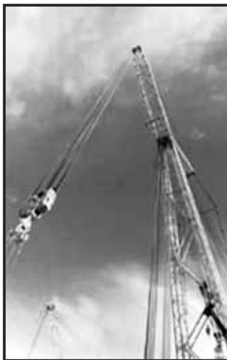
SGC-250 zvedne s jibem až 4250tun při vyložení 40 metrů. Ve vzdálenosti 165 metrů to je 775tun.
