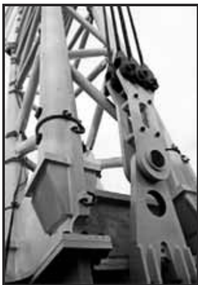
SGC-250 zvedne s jibem až 4250tun při vyložení 40 metrů. Ve vzdálenosti 165 metrů to je 775tun.
