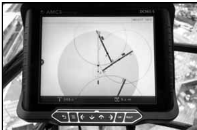
DCS 61-S od firmy AMCS monitoruje v reálném čase riziko kolize částí jeřábu
