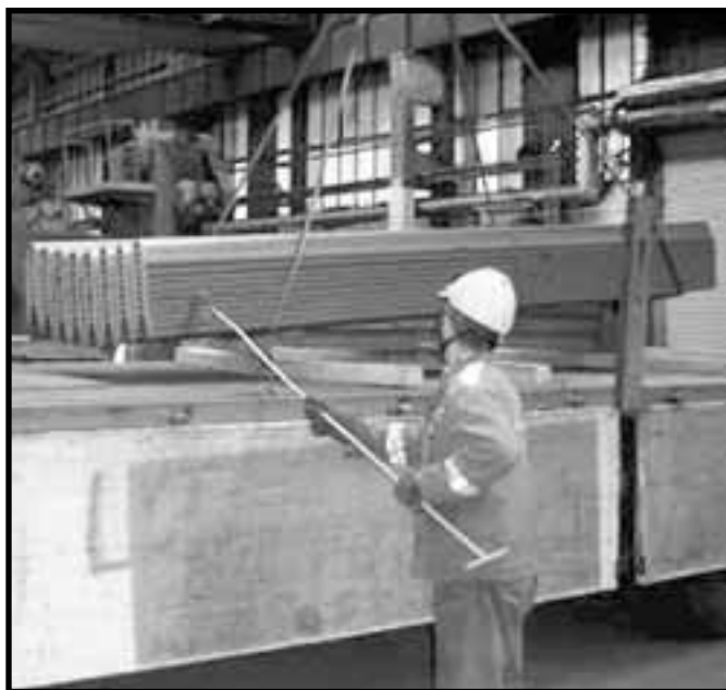
Obr.2 Bezdotykové usměrnění břemene
