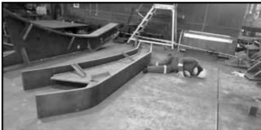
Obr. 4 Pád nestabilně uloženého břemene na vazače při odvazování vázacího prostředku
