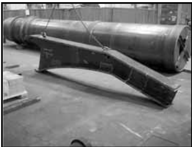
Obr.3 Nestabilně uložené břemeno
