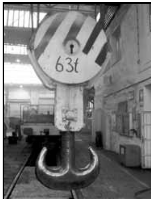
Obr. 5 Kladnice s dvojitým hákem 63 tun bez pojistky
