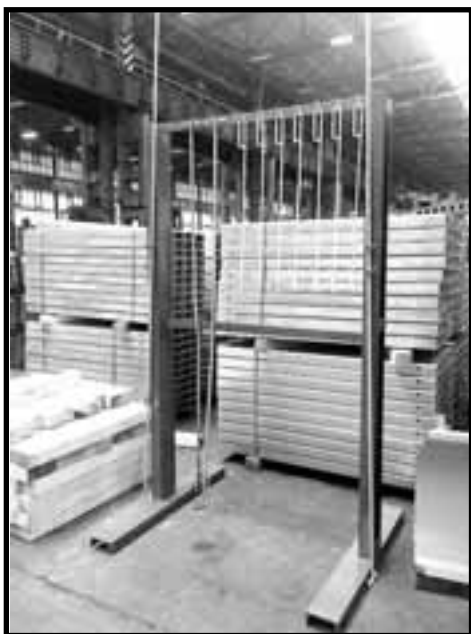
Obr.2 Bezdotykové usměrnění břemene
