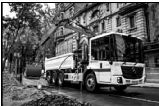
Jeřáb Epsilon na tomto novém Mercedesu Econic pro společnost Eurovia Contracting ve Velké Británii zvedá 3,7 tuny s dosahem 8,2 metru
