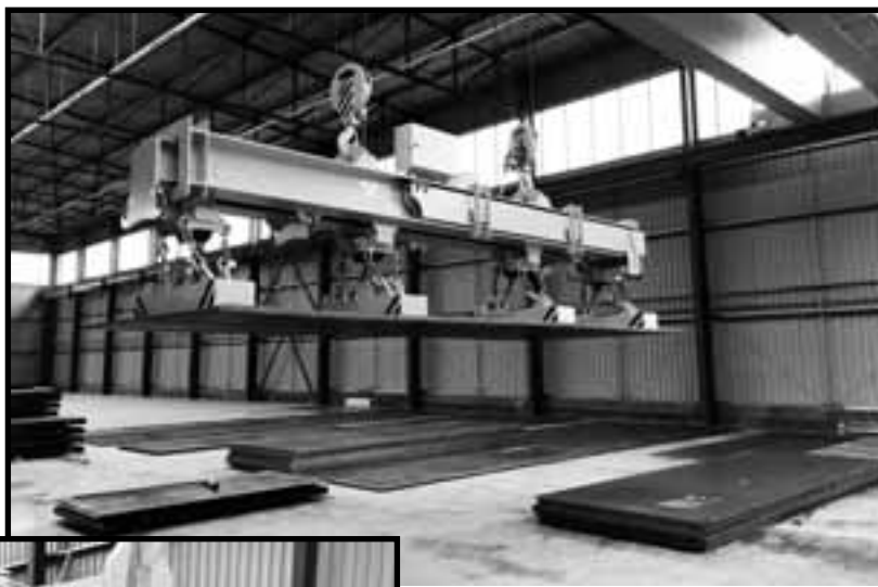
1) Manipulace plechů, nosnost 12t, motoricky ovládaná teleskopická traverza
