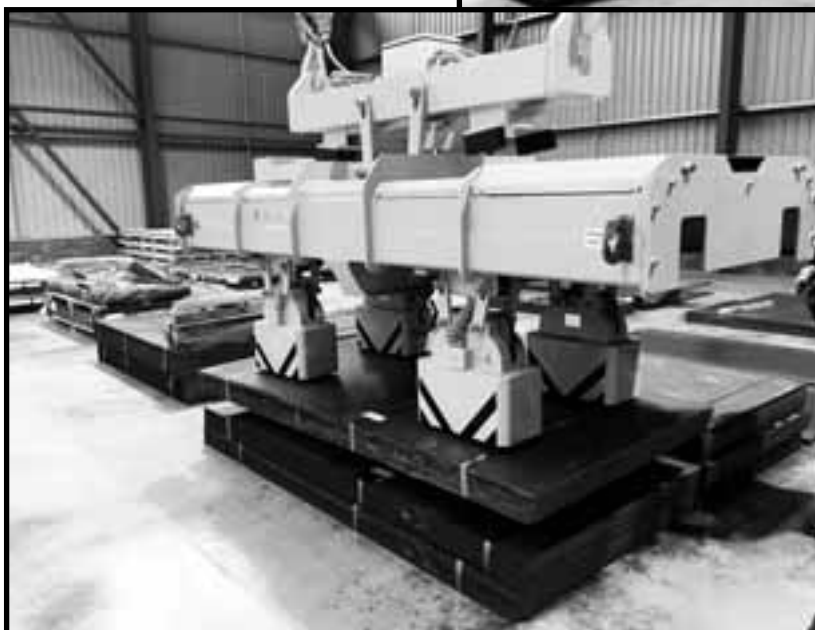
2) Manipulace plechů, nosnost 5t, motoricky ovládaná teleskopická traverza
