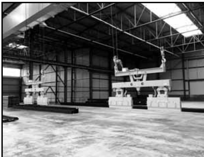
4) Manipulace jednotlivých profilů, nosnost 3,6t
