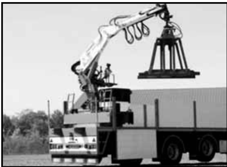
První elektrický nakládací jeřáb 16R Hyva Kennis e-Power dodávaný společností Hyva Benelux
