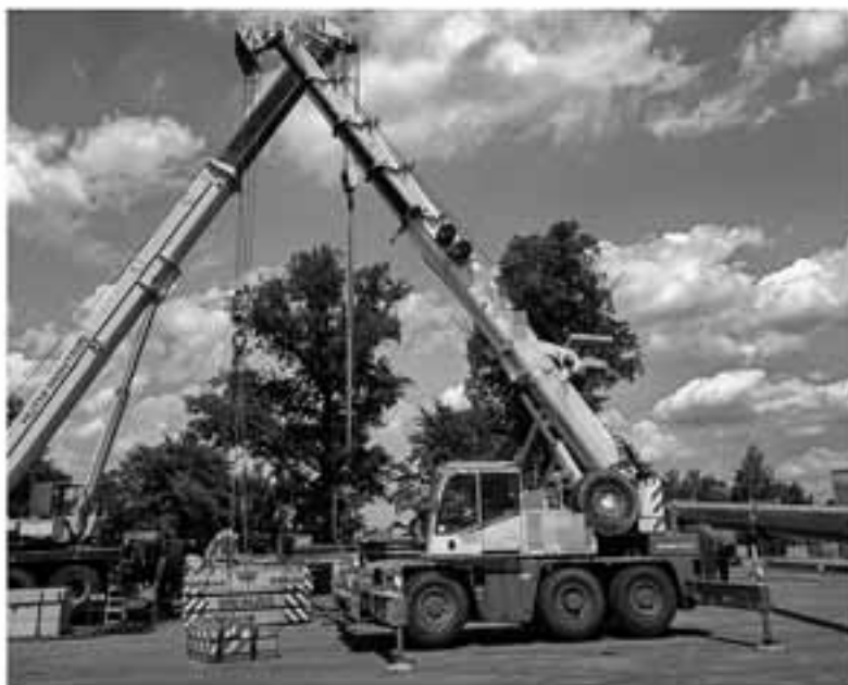
Terex-Demag AC40.1 Rok výroby 2008 Maximální nosnost 40 t
